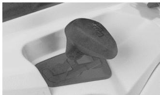
Изменение передачи выполняется только во время остановки. На холостых оборотах двигателя передвиньте рычаг переключения передач на требуемую передачу. Не пытайтесь переключать передачи во время движения или на оборотах двигателя, превышающих холостые.
